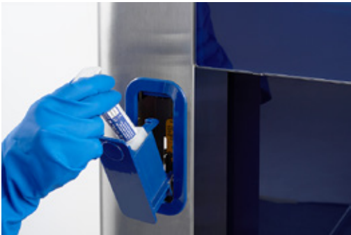
Sistema ergonomico di caricamento frontale della cartuccia con design "poka-yoke", che evita totalmente gli errori dell'operatore.
